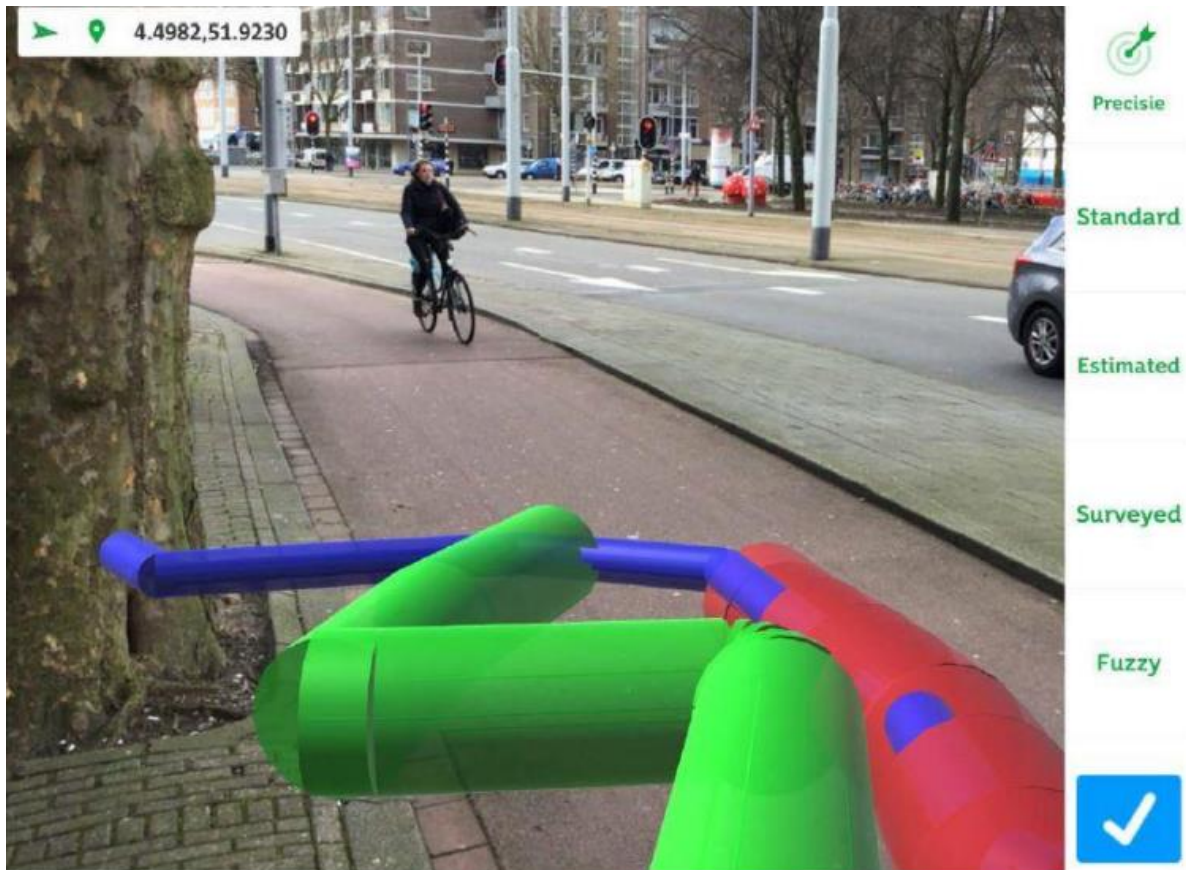
Зураг 26 Газар доорх шугам сүлжээний өгөгдлийн тодорхой бус байдлыг тодруулах зорилгоор 3D дүрслэлд AR болон Fuzzy технологийг ашигласан байдал
